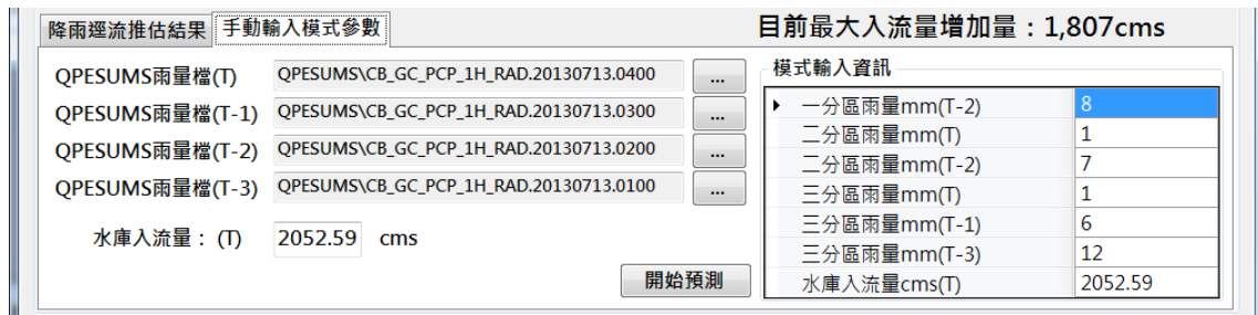
圖 10-4-2 石門水庫入流量推估模組手動輸入模式參數介面
